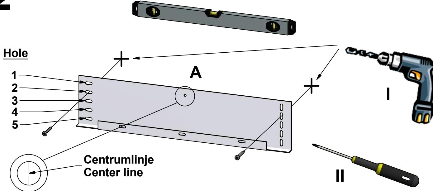
Skruvinfästningar i våtzon 1 ska göras i betong eller annan massiv konstruktion, träreglar, tråkortlingar eller i konstruktion som är provad och godkänd för infästning, till exempel skivkonstruktion. Se exempel på godkända konstruktioner på säkervatten.se.
