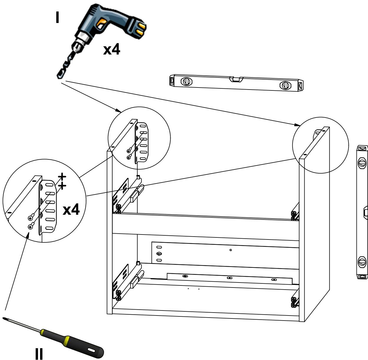
Skruvinfästningar i våzon 1 ska göras i betong eller annan massiv konstruktion, träreglar, trækortlingar eller i konstruktion som är provad och godkänd för infästning, till exempel skivkonstruktion. Se exempel på godkända konstruktioner på säkervatten.se.
